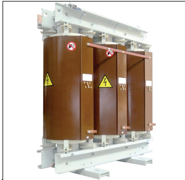
Figura 10: trasformatori di potenza del tipo a secco con avvolgimenti inglobati sotto vuoto
