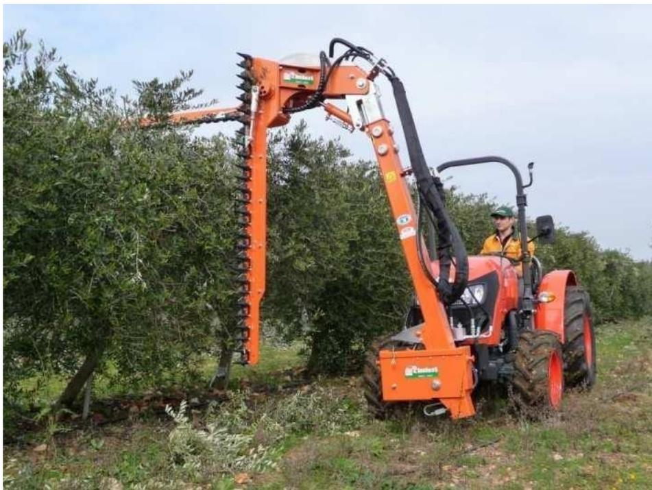
*Figura 7 - Esempio di potatrice meccanica frontale a doppia barra (taglio verticale + topping) utilizzabile su tutti le colture arboree intensive e superintensive*
