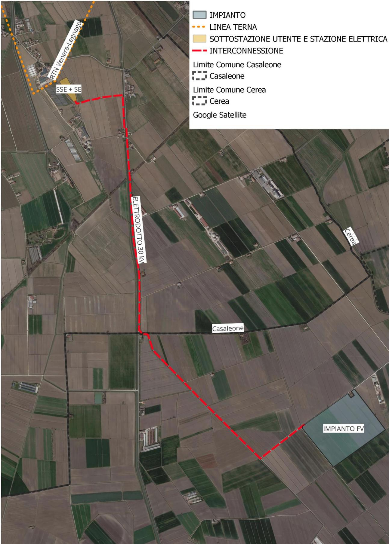
Il generatore fotovoltaico si estenderà su una superficie di terreno a destinazione agricola insistente nel territorio del comune di Cerea (VR). Di seguito si riportano le caratteristiche principali dell'impianto:
