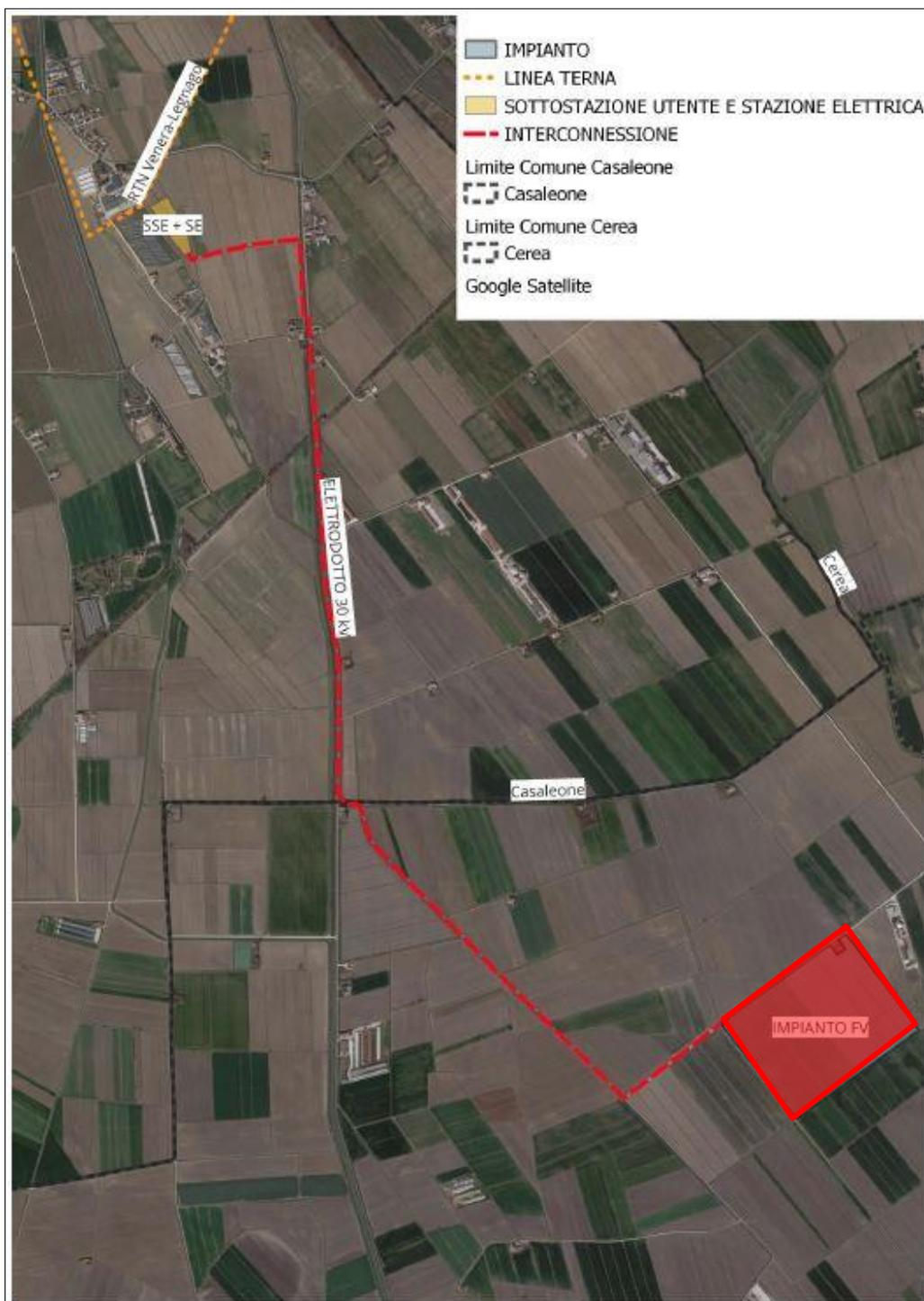
Figura 1: Ubicazione impianto FV e linea elettrica di collegamento
