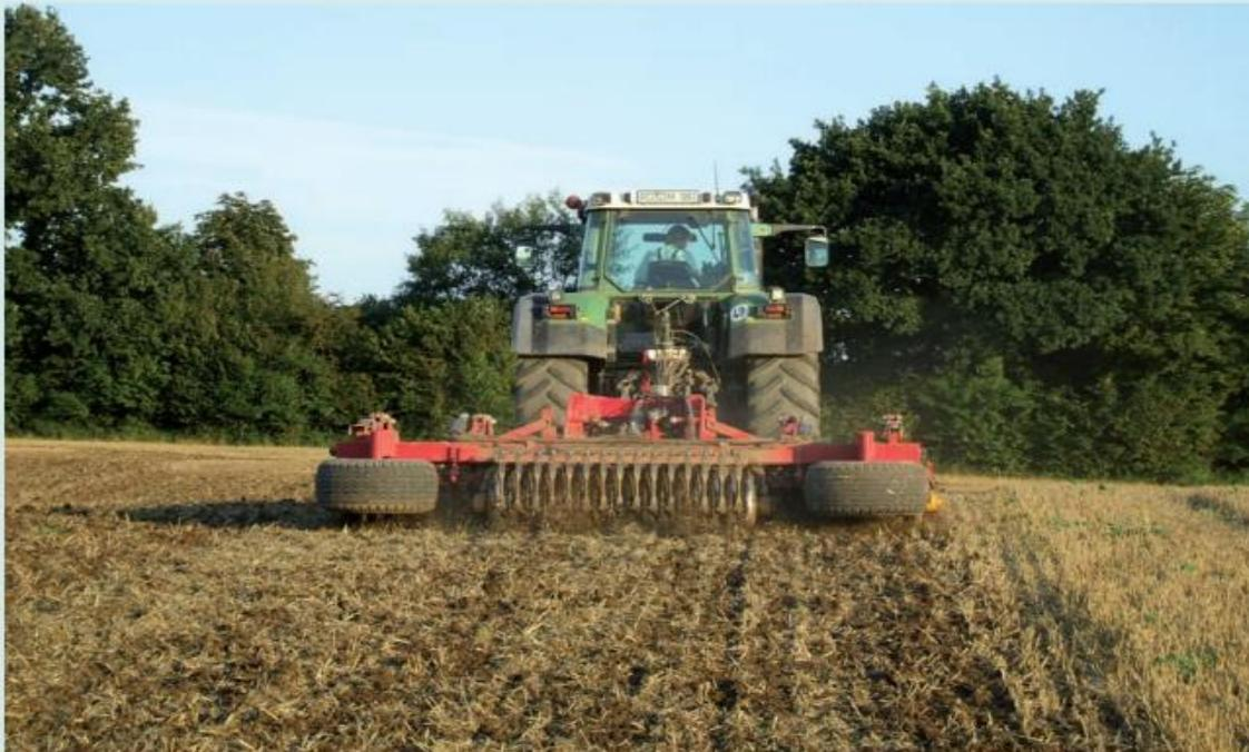
*Aratro a dischi usato per le operazioni colturali di lavorazione ridotta (Germania)
