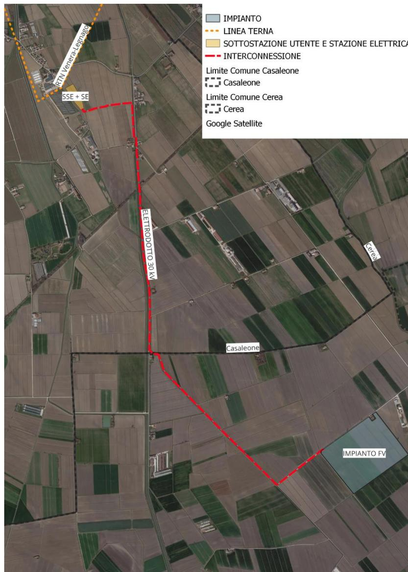
Nell'immagine satellitare, si evince l'area occupata dall'impianto agrivoltaico, l'area destinata alla realizzazione della nuova stazione utente e stazione elettrica e l'elettrodotto a 30 kV in collegamento.
