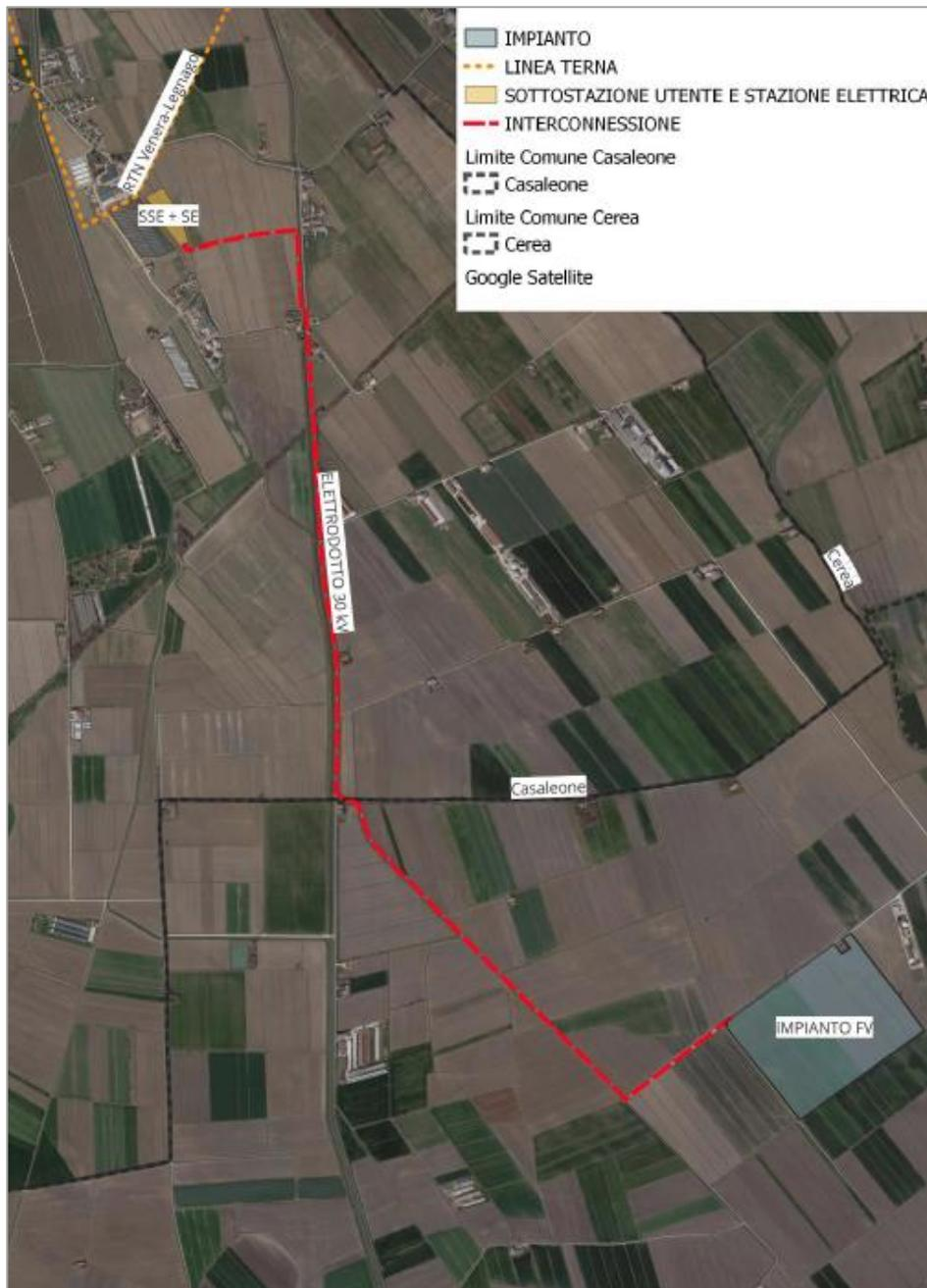
Figura 4.4 Ortofoto dell'area occupata dall'impianto fotovoltaico (in verde), dell'elettrodotto (linea rossa) collegato a 30 kV a una nuova stazione utente e stazione elettrica (in arancione)
