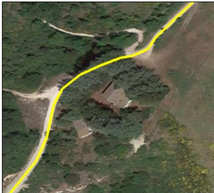
**Figura 12** – Ricettore R1 interno all'area d'impianto e cavidotto di evacuazione (in giallo)
