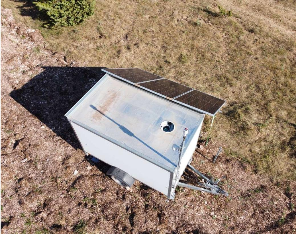
*Figura 3: LIDAR completo di sistema di alimentazione, contenimento/protezione e sorveglianza; si noti che il LIDAR vero e proprio si trova all'interno della struttura mostrata in figura in modo da essere protetto dagli agenti atmosferici, manomissioni, animali ecc.*
