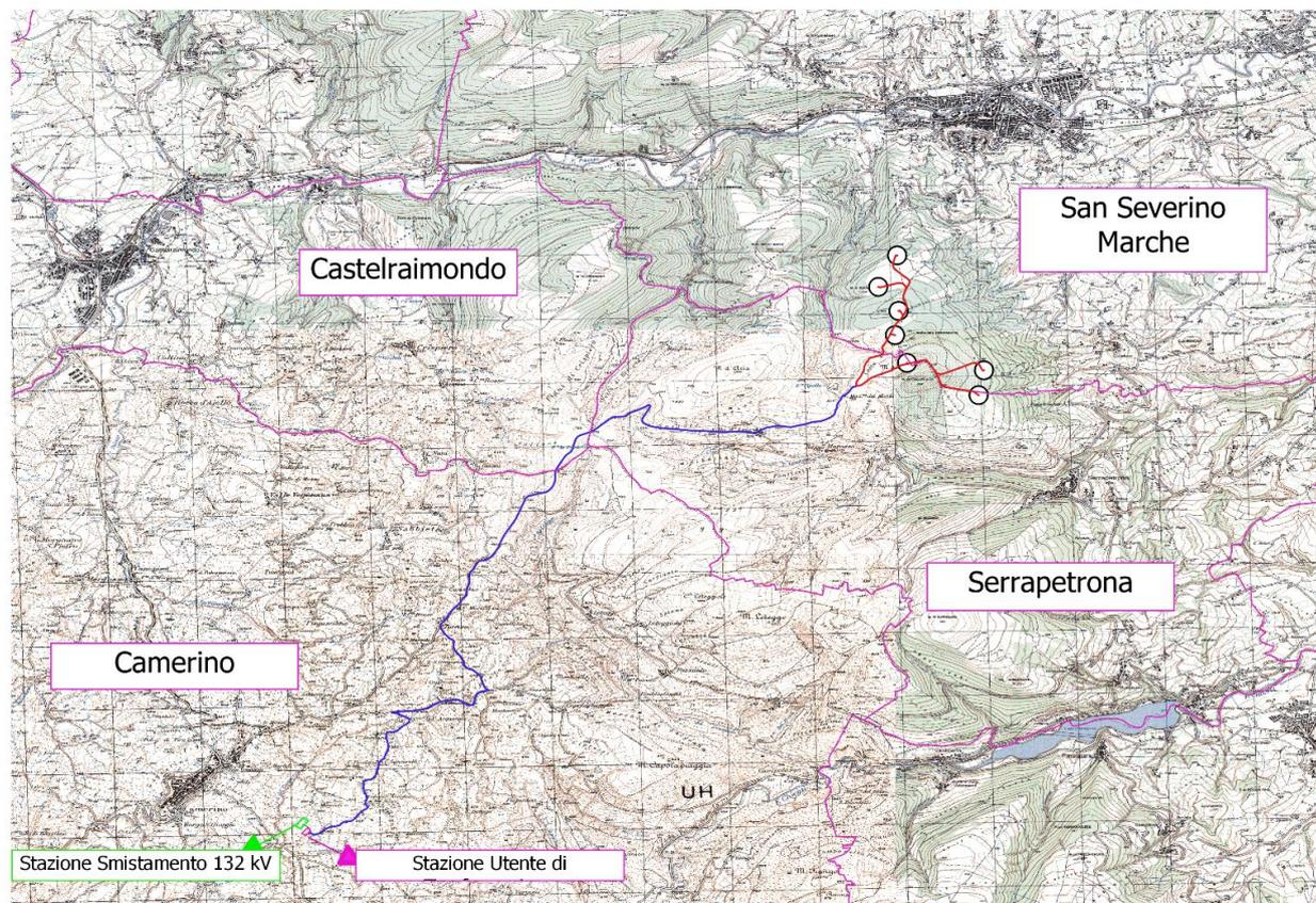
Figura 1: Stralcio di cartografia IGM della zona con ubicazione dell'area d'impianto e dell'area occupata dalle opere accessorie per il collegamento alla rete elettrica nazionale.
