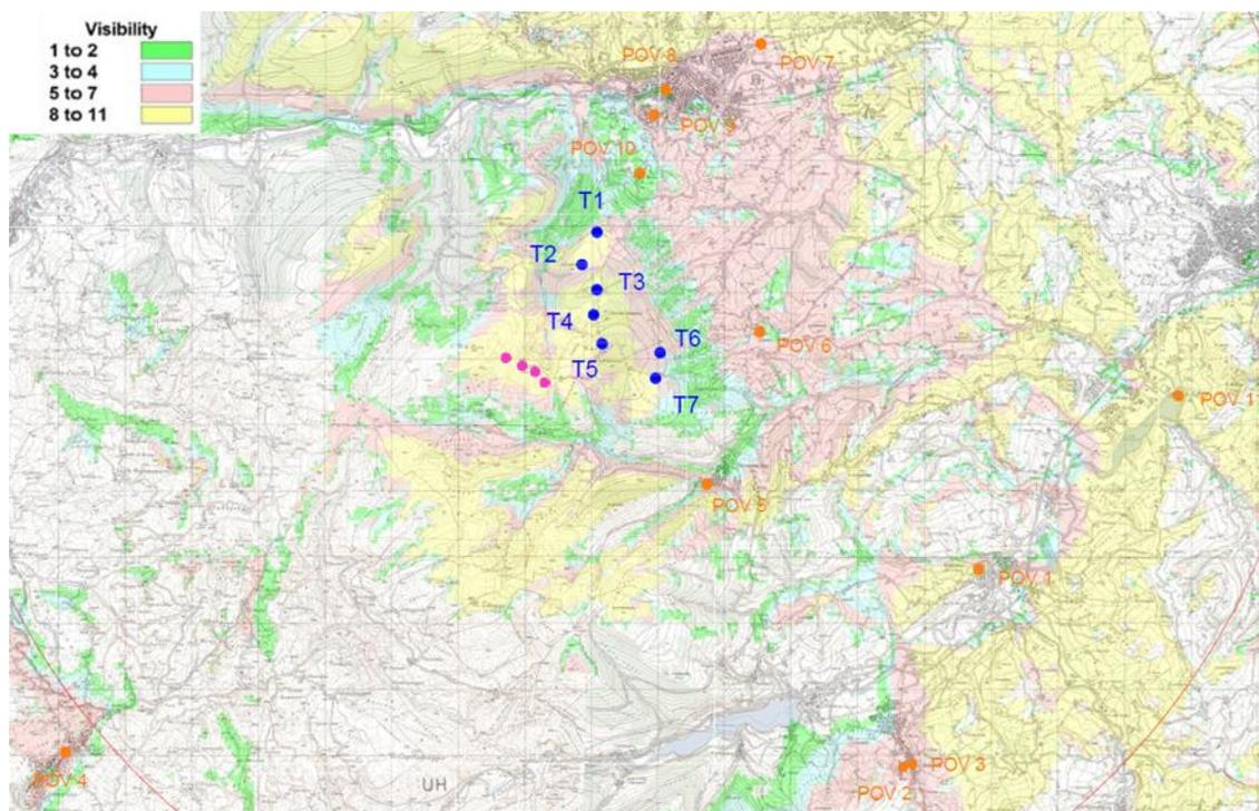
Figura 13 – Stralcio di cartografia IGM 1:25000 con indicazione delle di visibilità degli aerogeneratori, in progetto (in blu) ed esistenti (in fuxia), e dei ricettori (in arancione) – caso 2.
