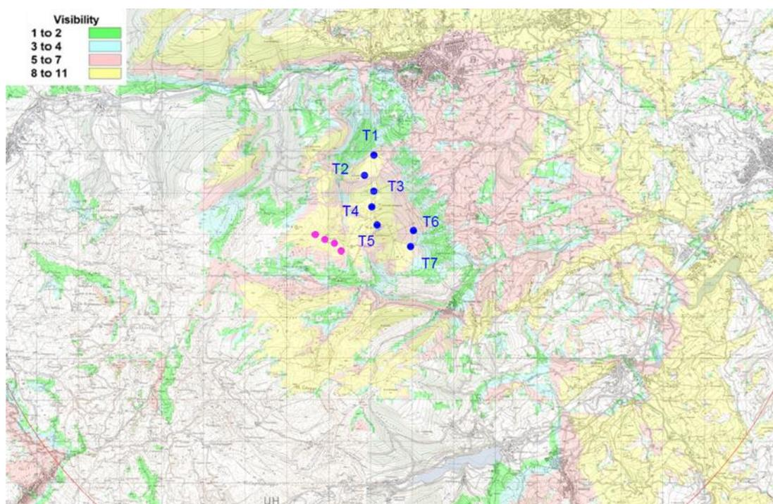
Figura 12 – Stralcio di cartografia IGM 1:25000 con indicazione delle zone di visibilità degli aerogeneratori, in progetto (in blu) ed esistenti (in fuxia) – caso 2.
