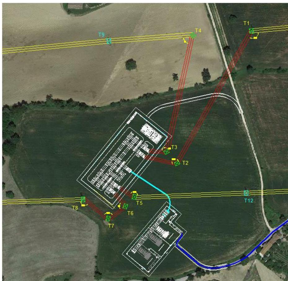
Figura 8: Stralcio di ortofoto con la posizione della Stazione Utente SU, del cavidotto in AT (in ciano), della Stazione Elettrica SE e dei raccordi (in rosso).
