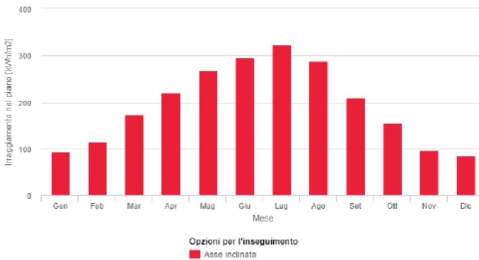
Figura 8. Irraggiamento mensile nel piano di inseguimento FV (per 1 kWp)
