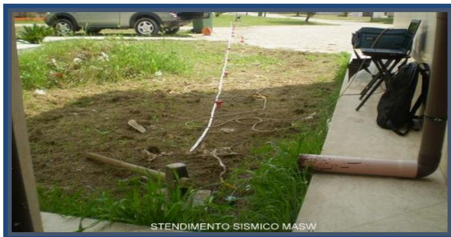
**Figura 2: ESEMPIO DI STENDIMENTO SISMICO**
