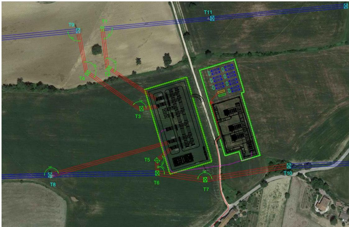
Figura 7 – Stralcio su ortofoto della posizione del sistema di accumulo (BESS), della Stazione Utente, del cavidotto in AT e della Stazione di Smistamento 132 kV
