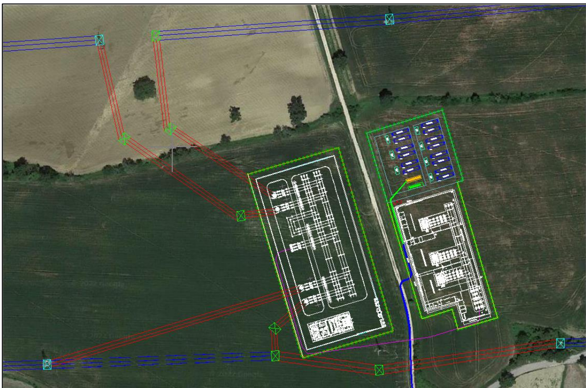
Figura 17: Inquadramento su ortofoto: stazione utente collegata con la stazione elettrica di smistamento a 132 kV da realizzare in località di "Arcofiato", il cavidotto in AT di collegamento condiviso (in magenta).
