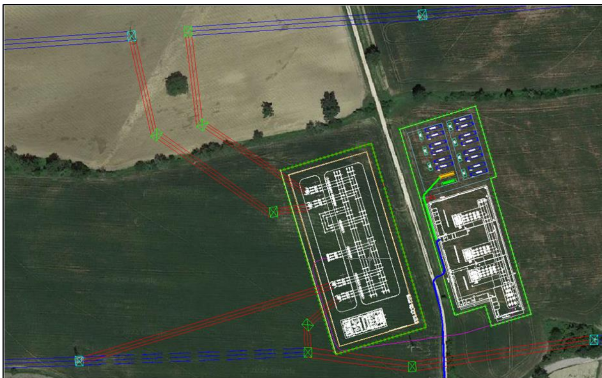
Figura 8: Stralcio di ortofoto con la posizione della Stazione Utente di trasformazione e della Stazione Elettrica di smistamento, i cavidotti, i raccordi e l'Impianto di accumulo.
