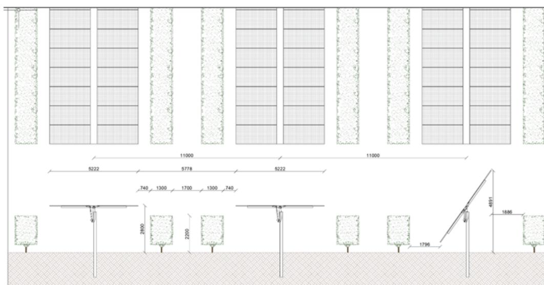
**Figura 12. Dettaglio layout impianto agri-voltaico**
