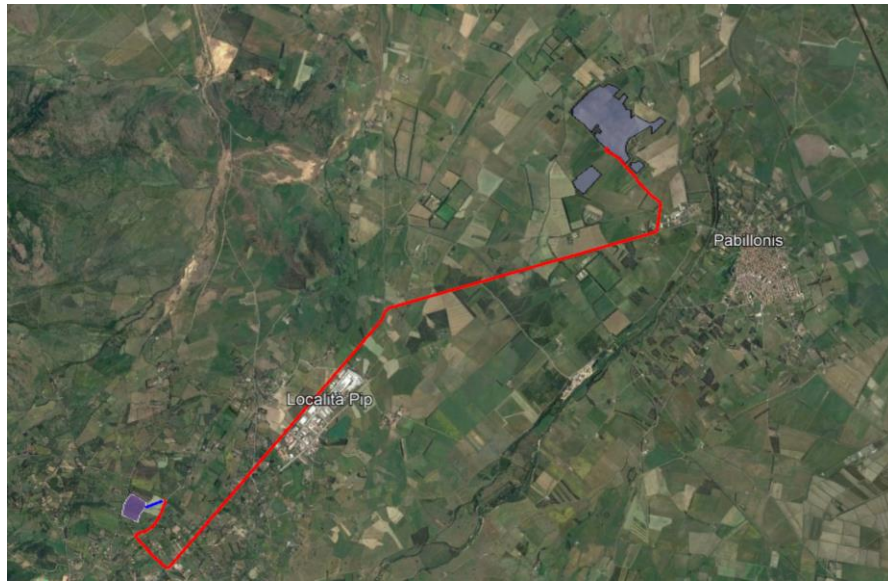
Figura 2 – Tracciato cavidotto MT verso SE
