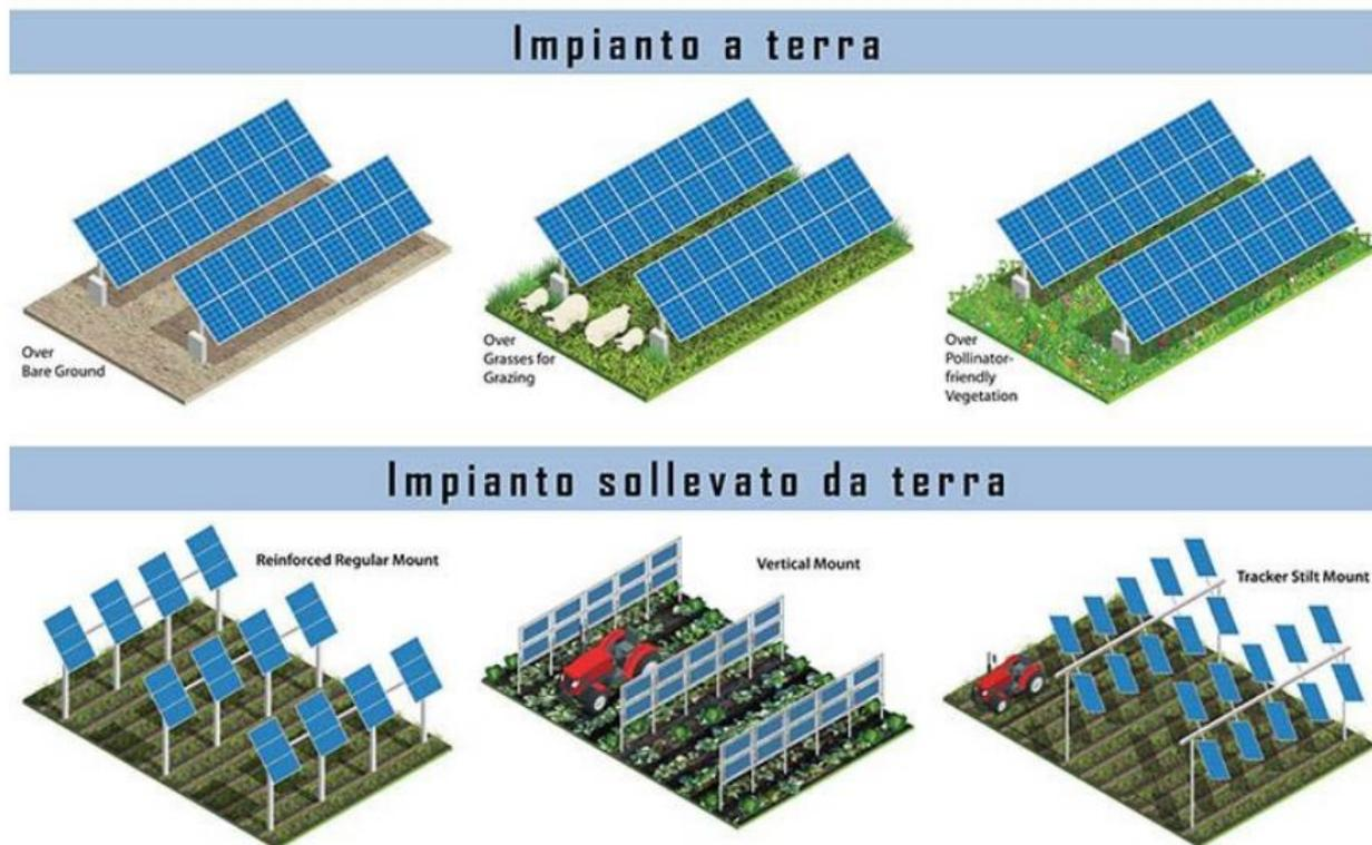
Figura 22 - Tipologie di impianti agrivoltaici, fonte NREL
