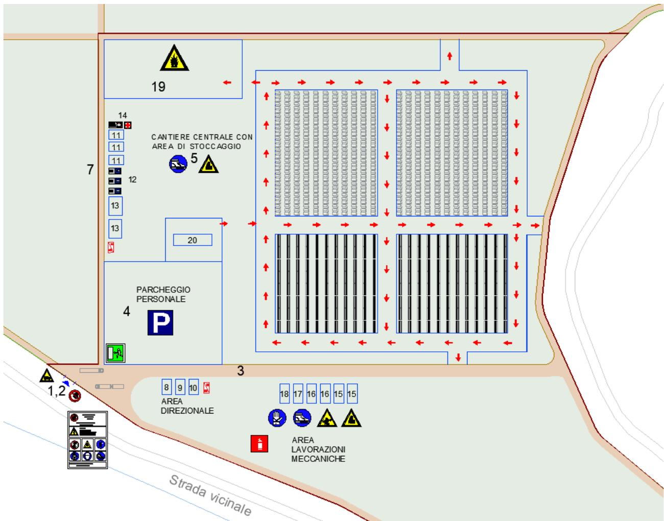
Figura 112 - Ricezione, stoccaggio e movimentazione materiali, dettaglio apprestamenti piastra 2a (cantiere 1)
