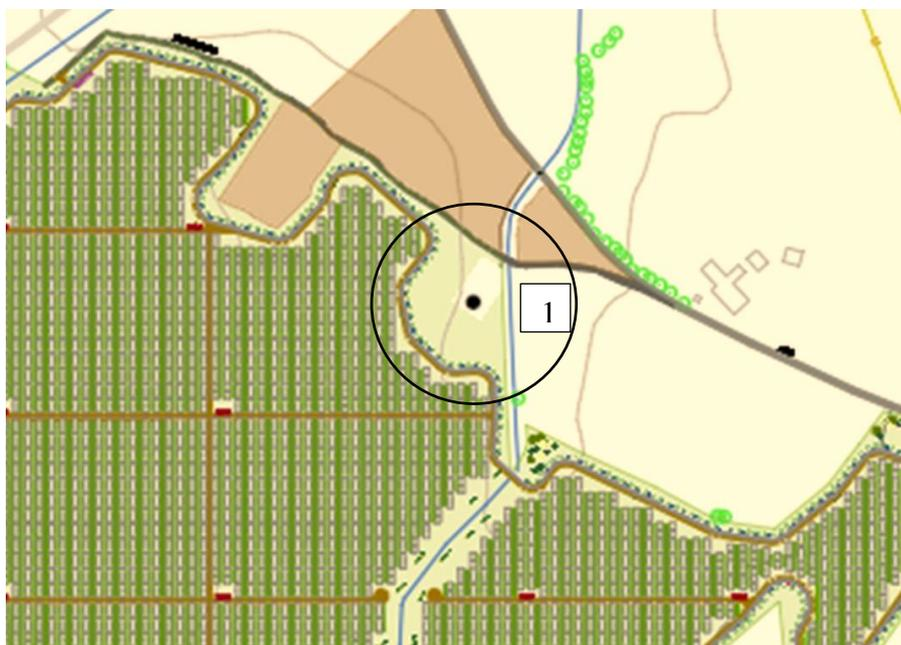
Figura 38 - Massima gittata di rottura pale e impianto fotovoltaico
