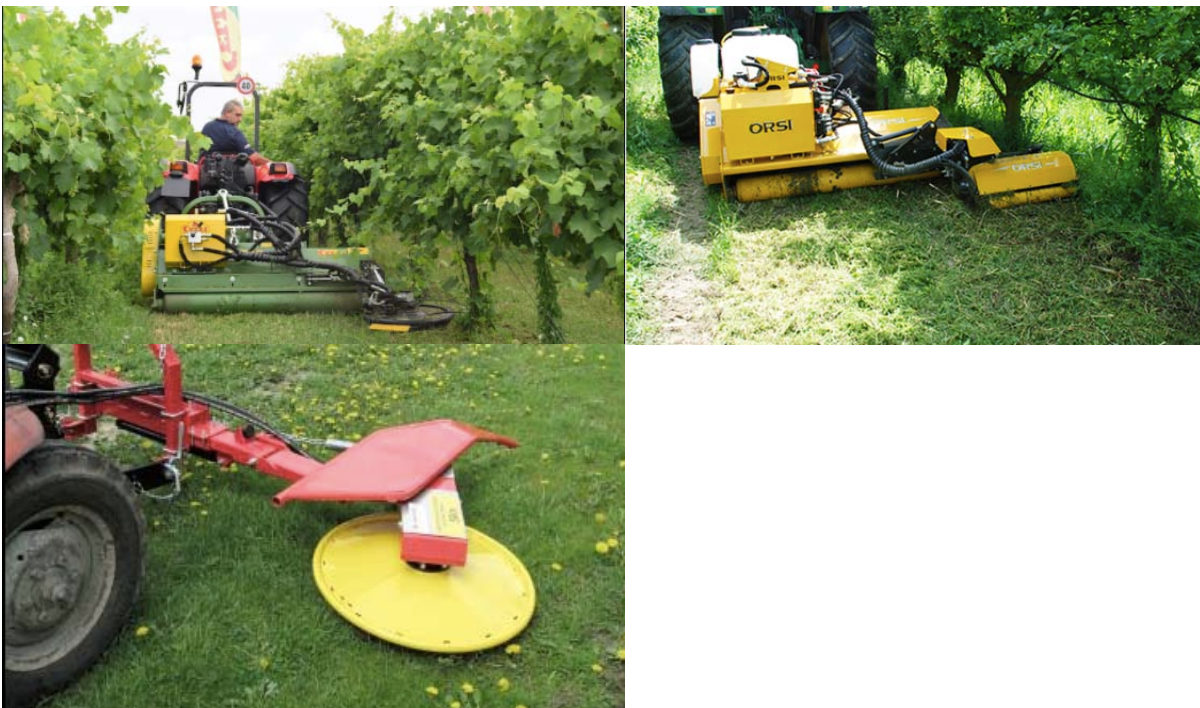
Figura 4-5-6: Fresa interceppo operativa in un vigneto
