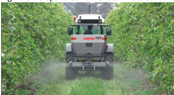
Figura 9-10 Spandiconcime localizzato sui soli filari
