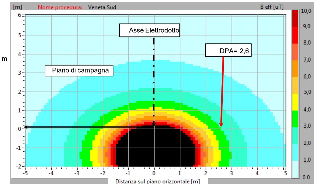
Figura 6 - Mappa verticale induzione magnetica (B) sezione tipo con indicazione della DPA -  $I = 900 A$
