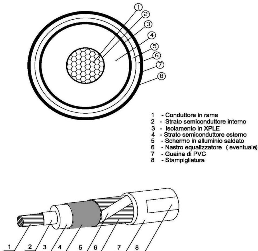
Figura 4 - Schema tipo cavo 150 kV
