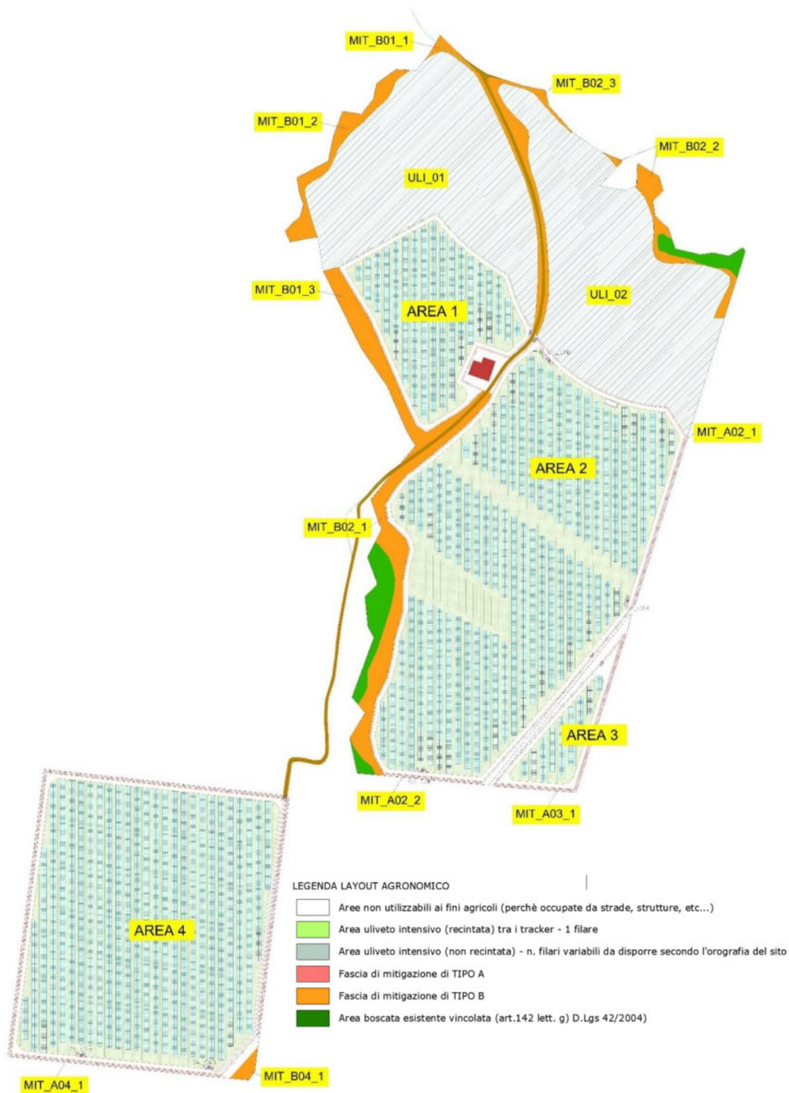
Figura 12.1. – Layout dell'impianto agrovoltaiico con l'indicazione delle diverse aree individuate dal progetto agronomico.
