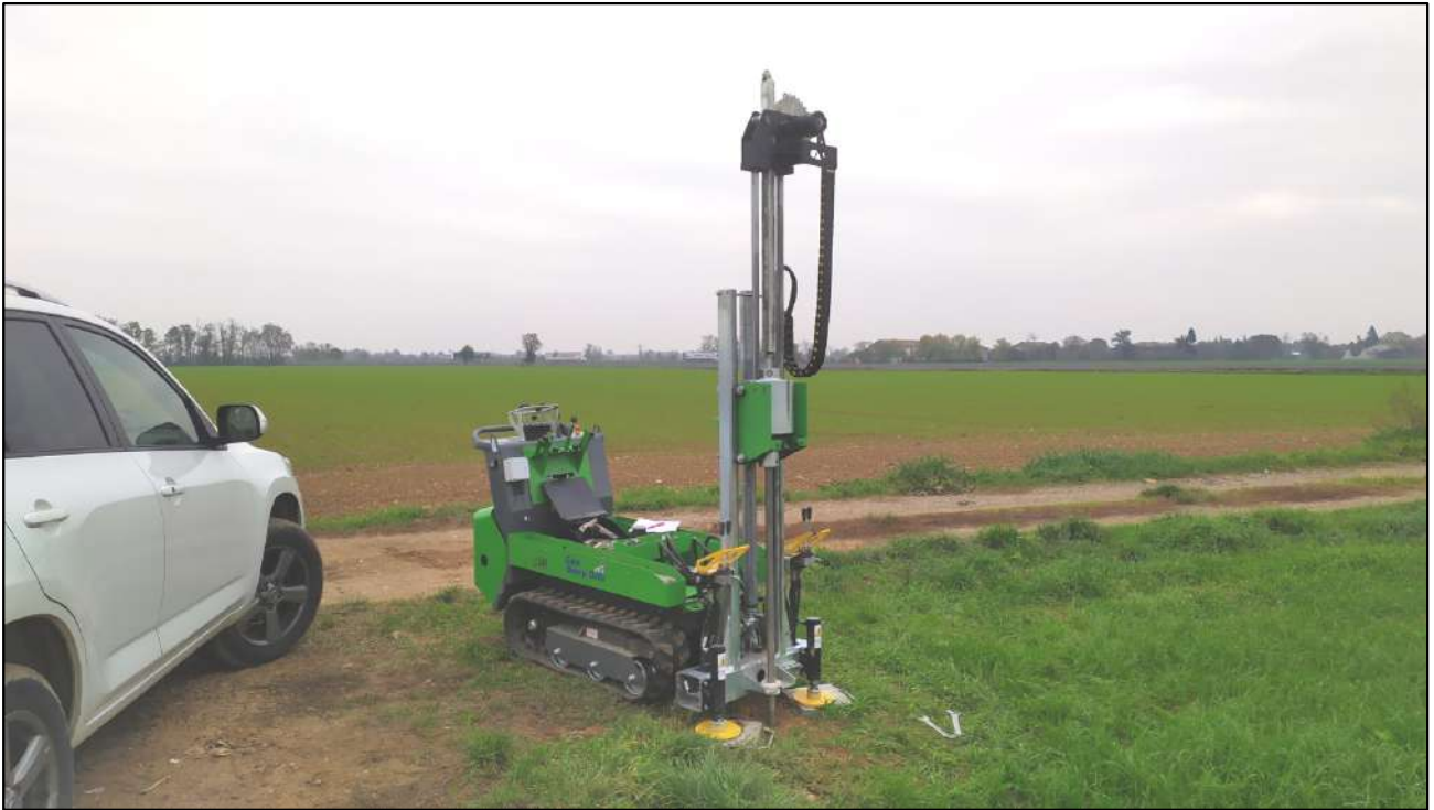
Foto n.3: Prova penetrometrica dinamica DPSH - P2
