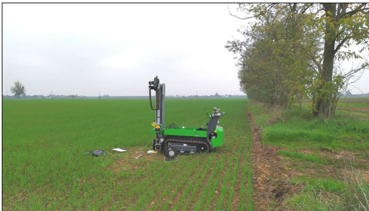
Foto n.1: Prova penetrometrica DPSH - P1
