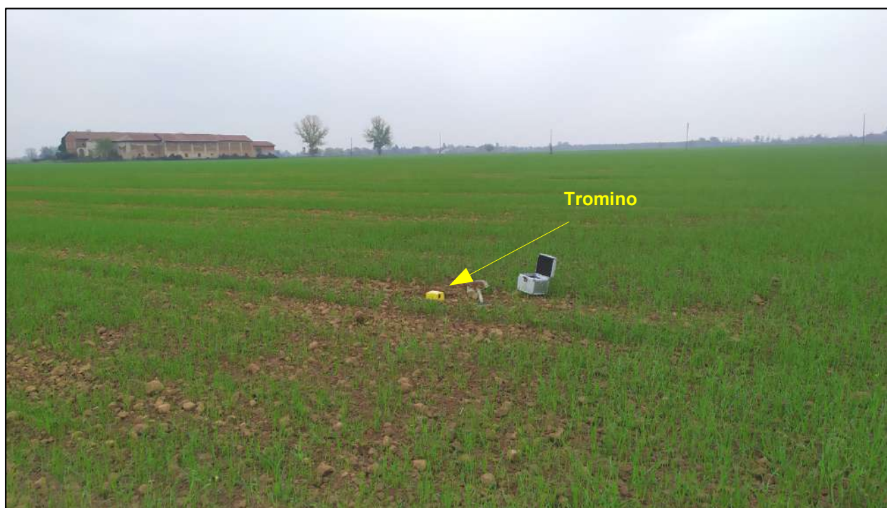
Foto n.2: Prova di sismica passiva H/V - S1, in prossimità della prova penetrometrica P1
