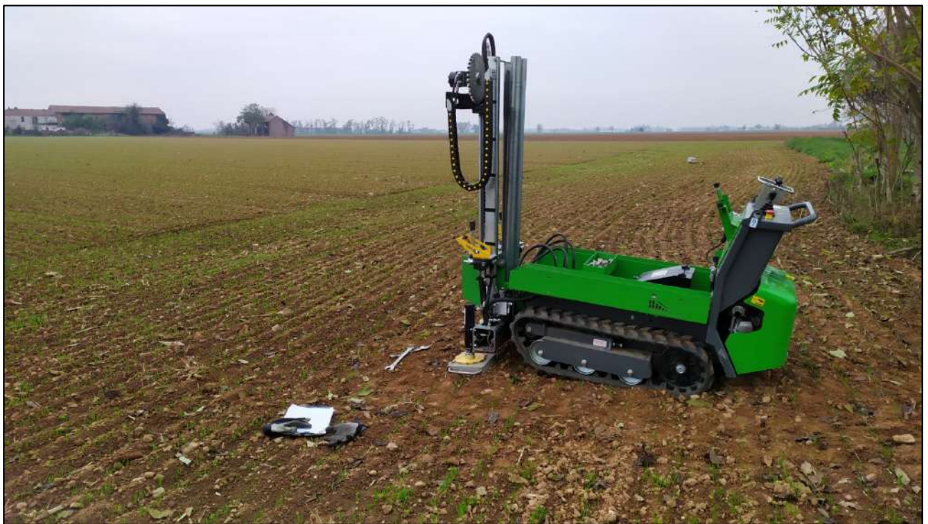
Foto n.4: Prova penetrometrica DPSH - P3
