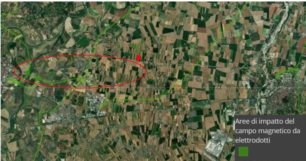
Figura 73 - Aree di impatto degli elettrodotti che definiscono la zona entro la quale è possibile che i livelli di campo magnetico siano significativi. Con la freccia rossa è indicato il posizionamento del parco proposto e con cerchio la zona indicativa di posizionamento della linea elettrica (geoportale Arpa Piemonte, dati 2020).
