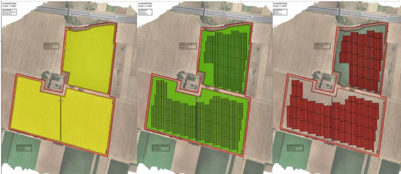
Figura 134 - Planimetrie di progetto raffiguranti la superficie totale dell'impianto (in giallo), quella agricola disponibile (in verde) e quella di ingombro dei moduli (in rosso) (Da tav. C\_14\_00. di progetto)
