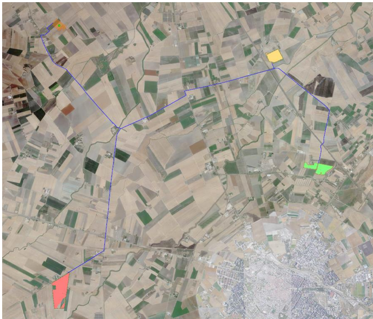
Figura 4.1: Percorso linea di connessione in cavidotto tra l'impianto fotovoltaico e la linea RTN a 380 kV "Foggia – San Severo"
