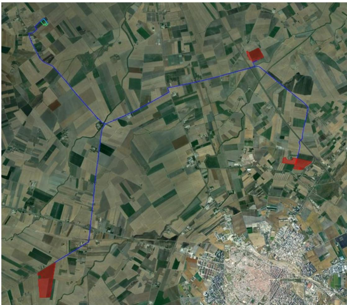
Figura 2.3: Soluzione di Connessione alla SE - In blu il percorso di connessione dal campo FV (aree rosse) alla nuova SE di Trasformazione (area verde)”
