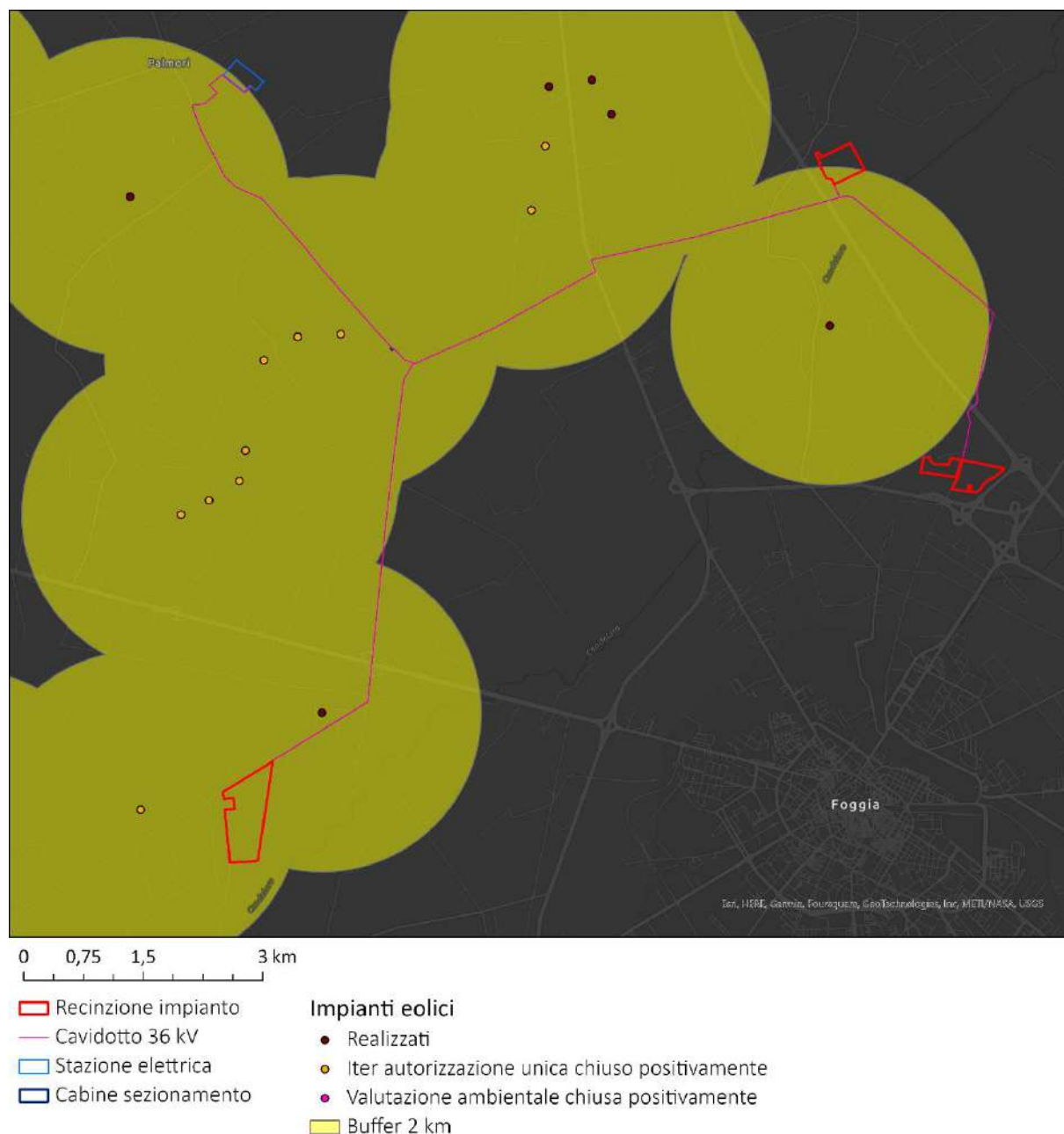
Figura 2.76: Individuazione degli impianti eolici presenti nell'area del dominio
