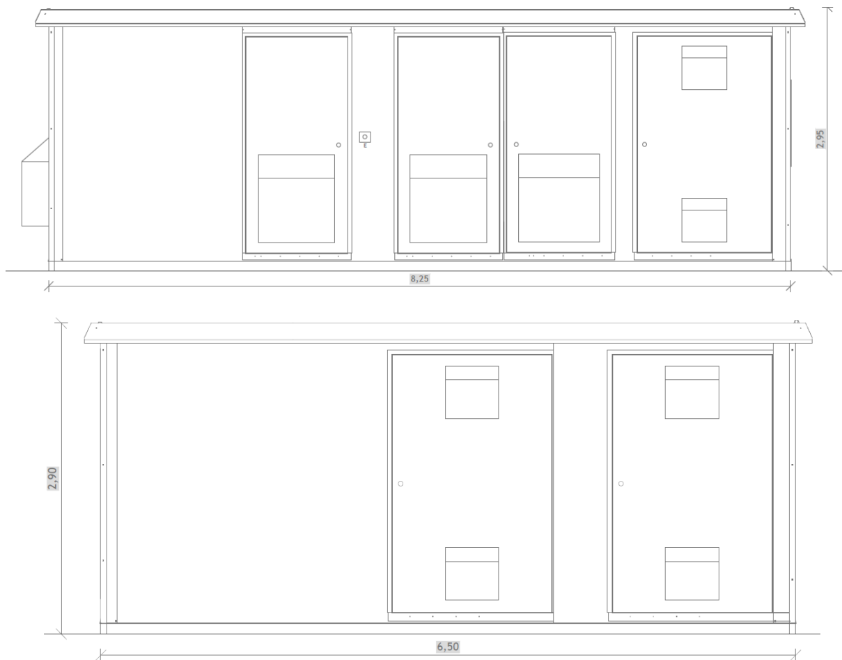
Figura 5. Pianta e prospetti della cabina di trasformazione
