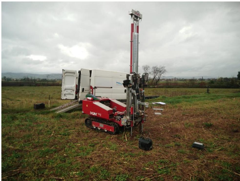
*Prova Penetrometrica Statica CPT 03 – Impianto Fotovoltaico*
