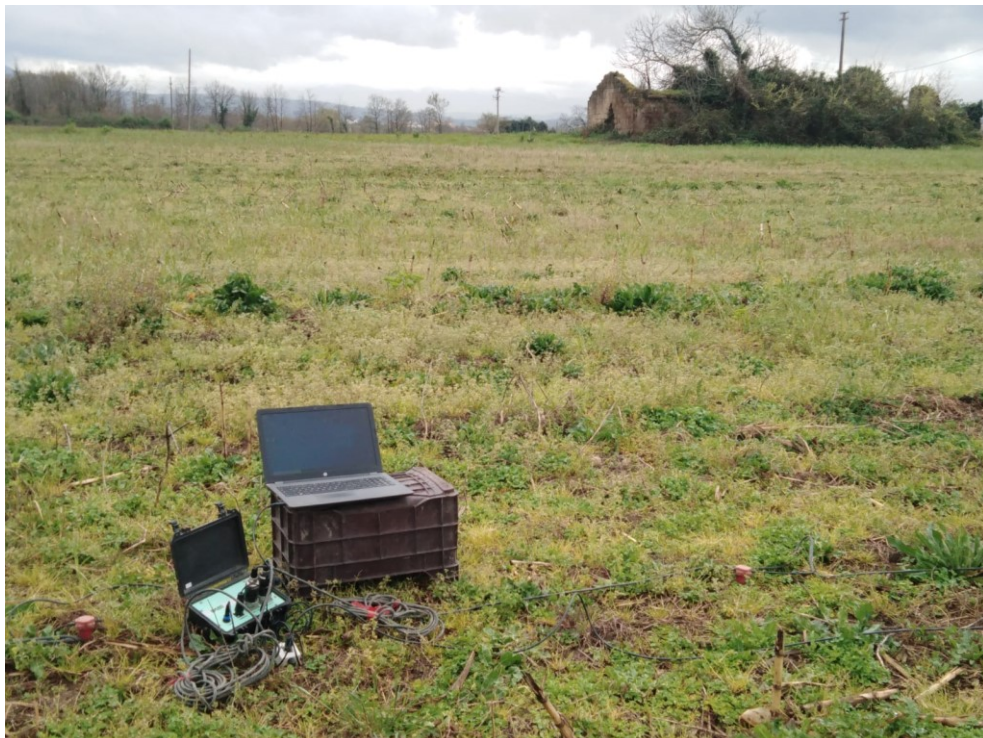
Figura Errata. Nel documento non esiste testo dello stile specificato.-1 Indagine sismica di superficie Masw M1
