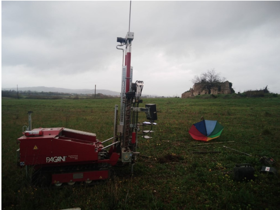
Prova Penetrometrica Dinamica Pesante DPSH 02 – Impianto Fotovoltaico
