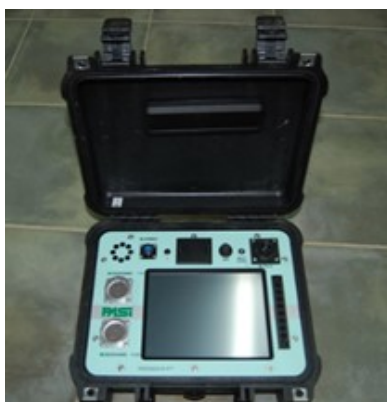
Figura Errore. Nel documento non esiste testo dello stile specificato.-6 Sismografo Pasi 16S24
