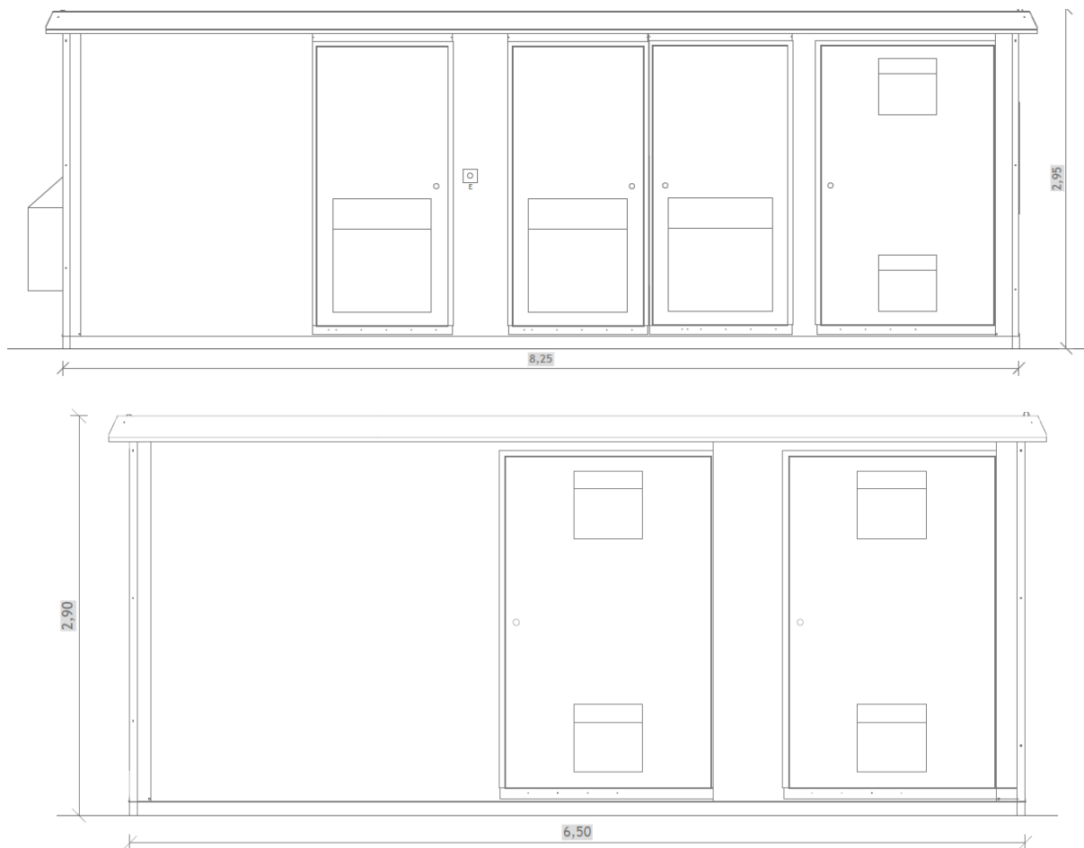
Figura 5. Pianta e prospetti della cabina di trasformazione
