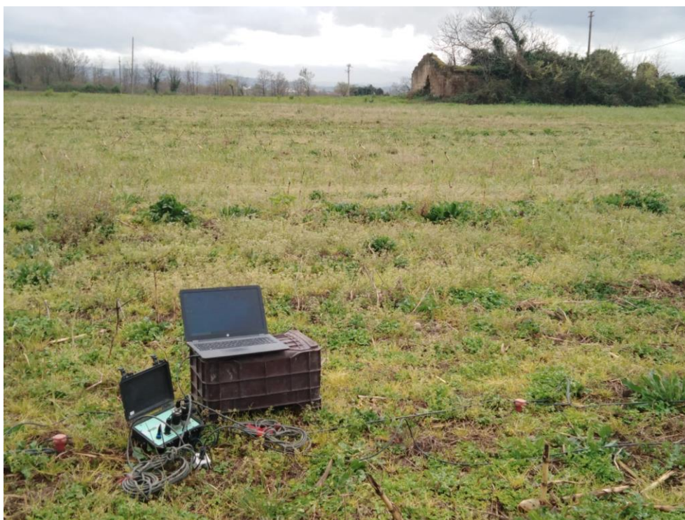
Figura Errore. Nel documento non esiste testo dello stile specificato.-1 Indagine sismica di superficie Masw M1
