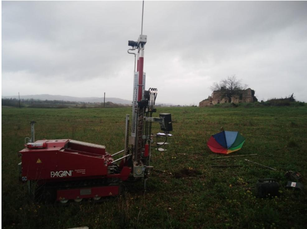
*Prova Penetrometrica Dinamica Pesante DPSH 02 – Impianto Fotovoltaico*
