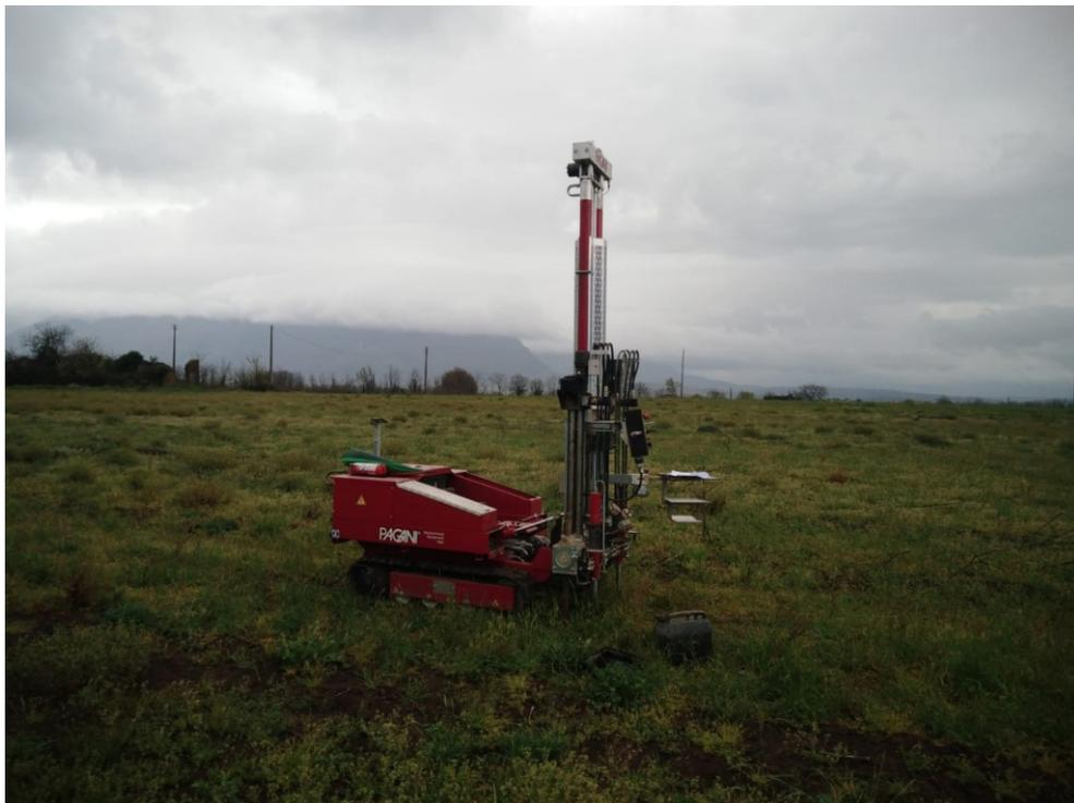
*Prova Penetrometrica Statica CPT 04 – Impianto Fotovoltaico*
