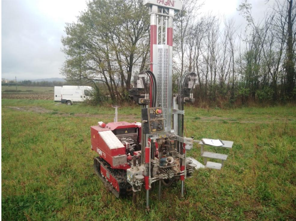
Prova Penetrometrica Statica CPT 01 – Impianto Fotovoltaico
