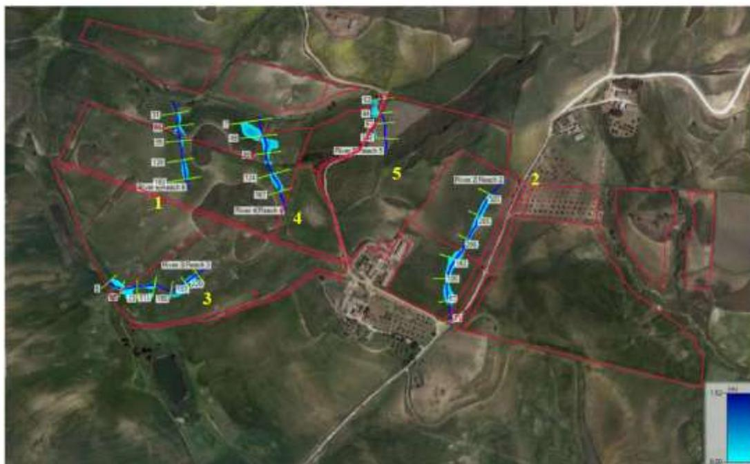
*Figura 26 – impluvi individuati con le relative altezze del tirante idraulico con TR100*
