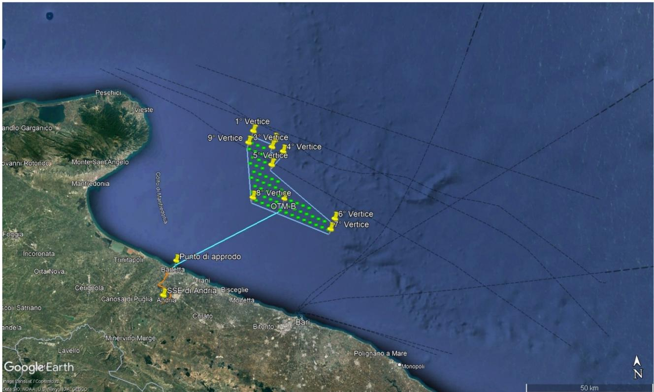
Fig. 3 – Ubicazione geografica su Google Earth, con l'indicazione dell'area floating e del tracciato del cavidotto sottomarino con approdo sul molo nord del porto di Barletta.
