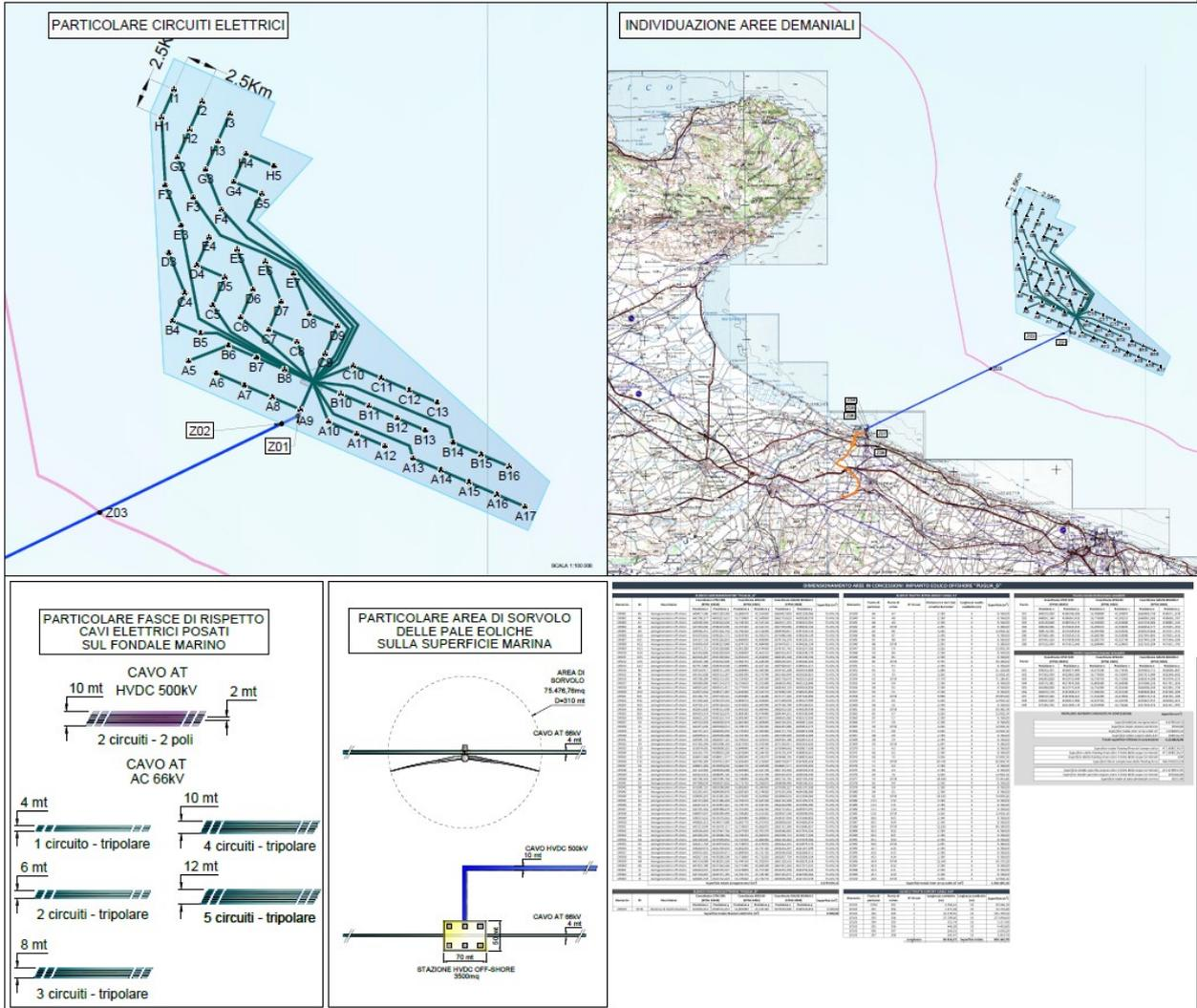
Figura 4: Layout Parco eolico e particolare delle aree richieste in Concessione.
