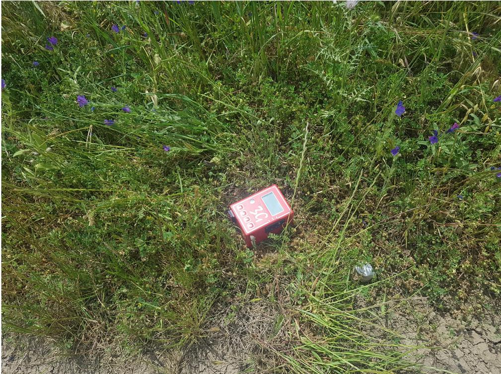
I dati sperimentali ricavati dalle indagini di sismica passiva a stazione singola permettono di ricavare una stima delle velocità delle onde di taglio  $V_s$ .
