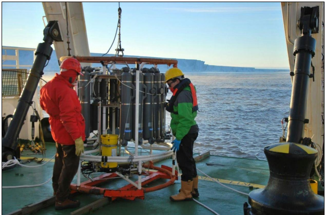
Figura 3: Campionatore d'acqua (rosetta) con sonda multiparametrica.
