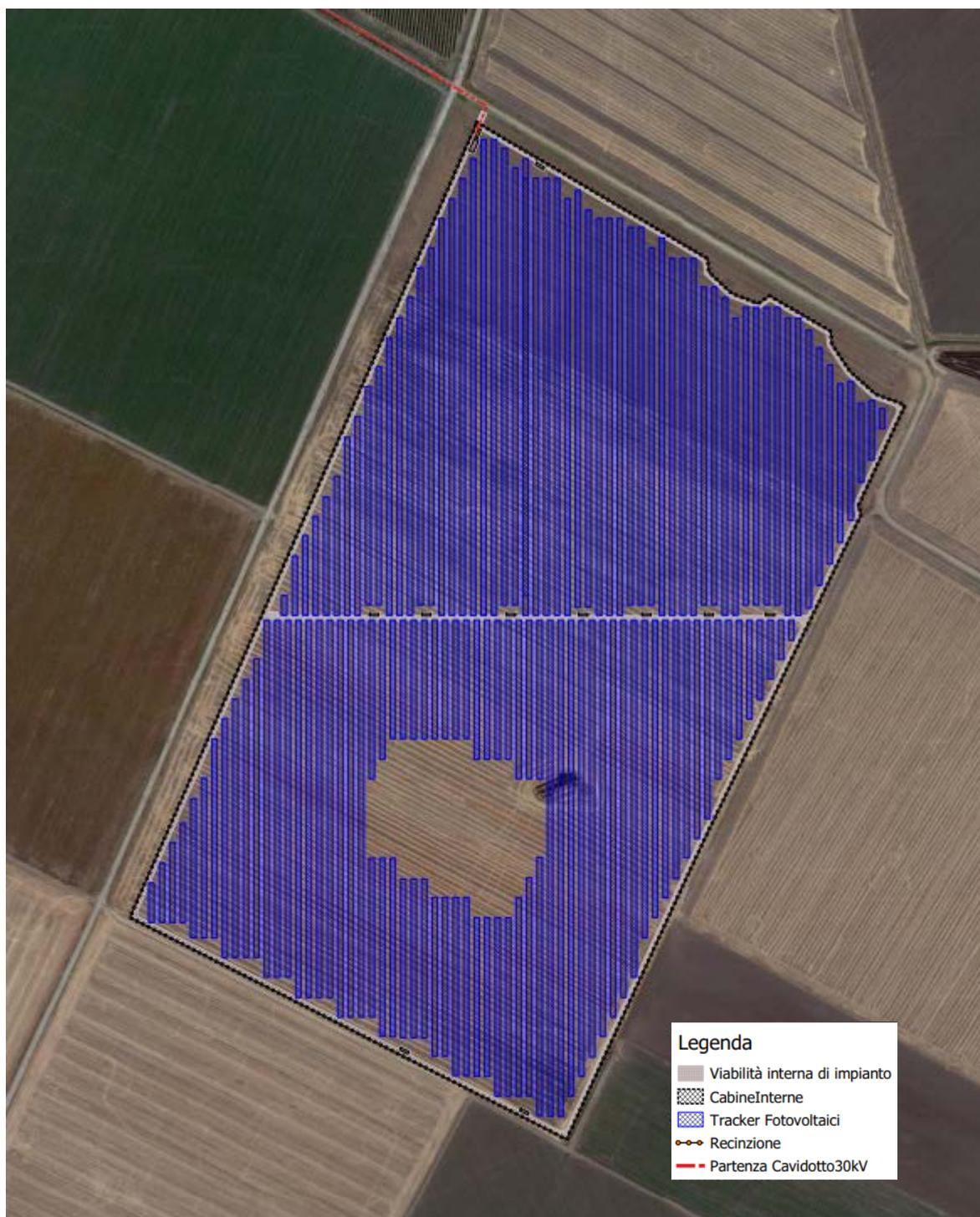
*Layout della sistemazione finale del sito: elementi della centrale fotovoltaica*
