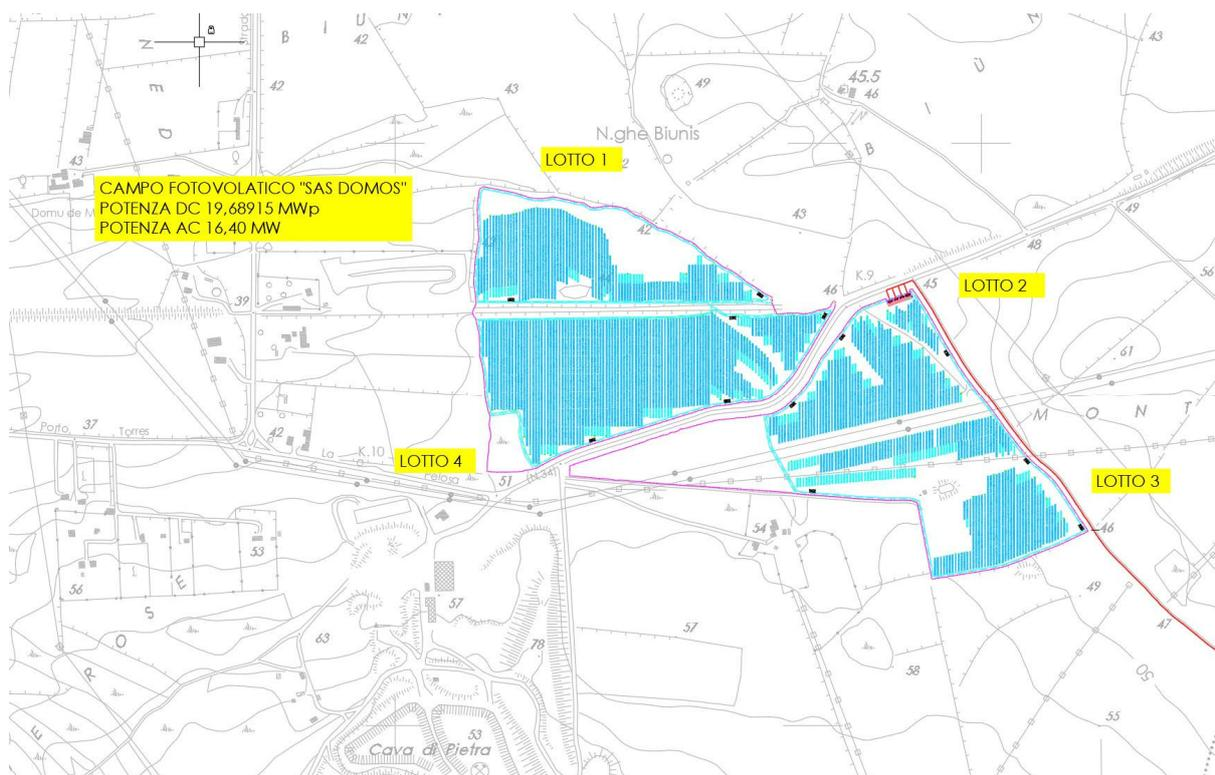
Fig. 2 Area d'impianto con individuazione settori
