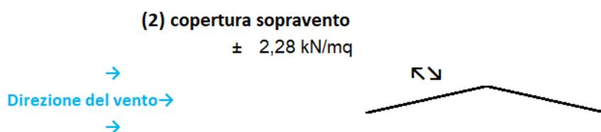
Valori medi della pressione per ogni elemento (da utilizzare per caricare il modello FEM)
