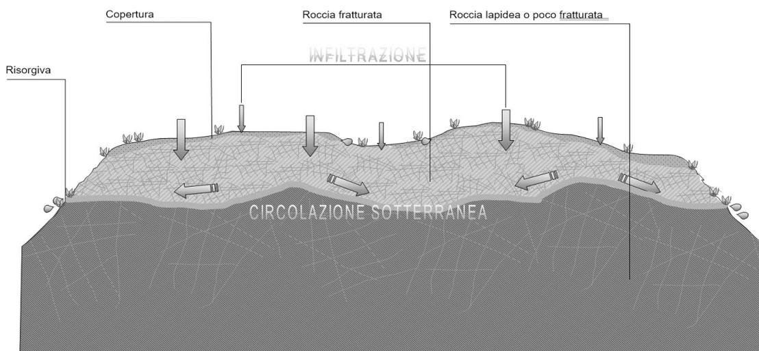
Figura 30 Schema esemplificativo, non in scala, dei processi di infiltrazione e deflusso sotterraneo
