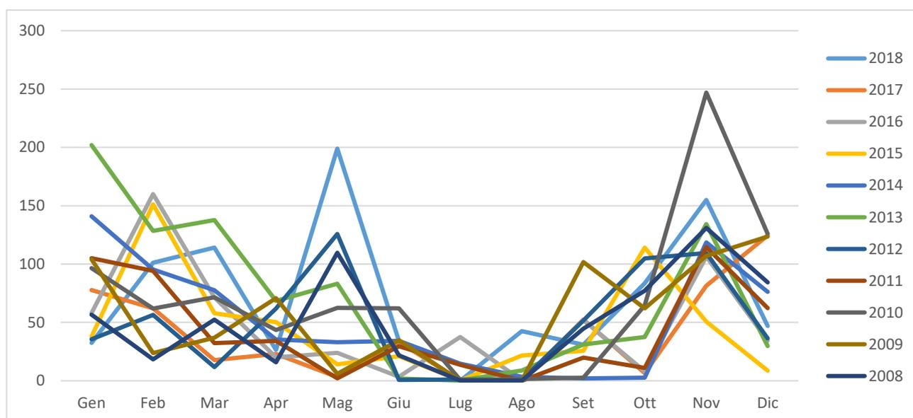
Figura 19 Andamento della pluviometria mensile e annuale (nell'asse delle ordinate, in mm) per le stazioni di Sassari (e Fertilia per il solo 2011) nel periodo 2008-2018.
