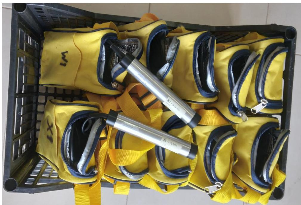
**Figura 10.** L'attrezzatura di rilevamento bioacustico utilizzata per il Monitoraggio della Chiroterofauna nell'Area di Studio vasta (Monitoraggio V.Ferri, 2021). Si tratta dei bat-detector Dodotronic Ultramic 384K, utilizzati con programmazione automatica presso stazioni di rilevamento fisso.
