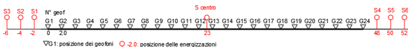
Figura 38 Schema geometrico di acquisizione dei dati per gli stendimenti di lunghezza L = 46,0 m
