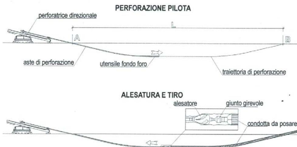
La posa del cavidotto MT mediante Trivellazione Orizzontale Controllata (TOC), con i rispettivi aspetti caratteristici è riportata all'interno del seguente documento:
