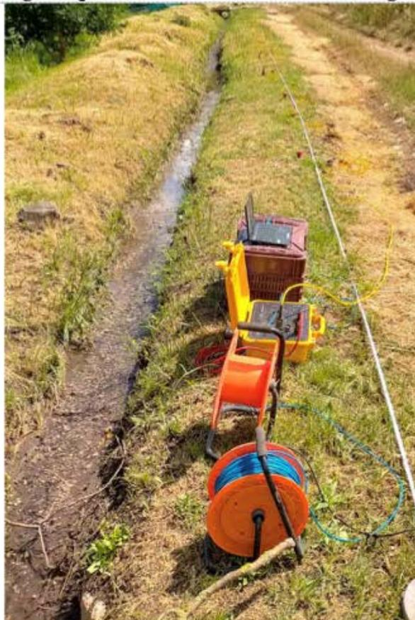
***Particolare dello stendimento sismico eseguito***
