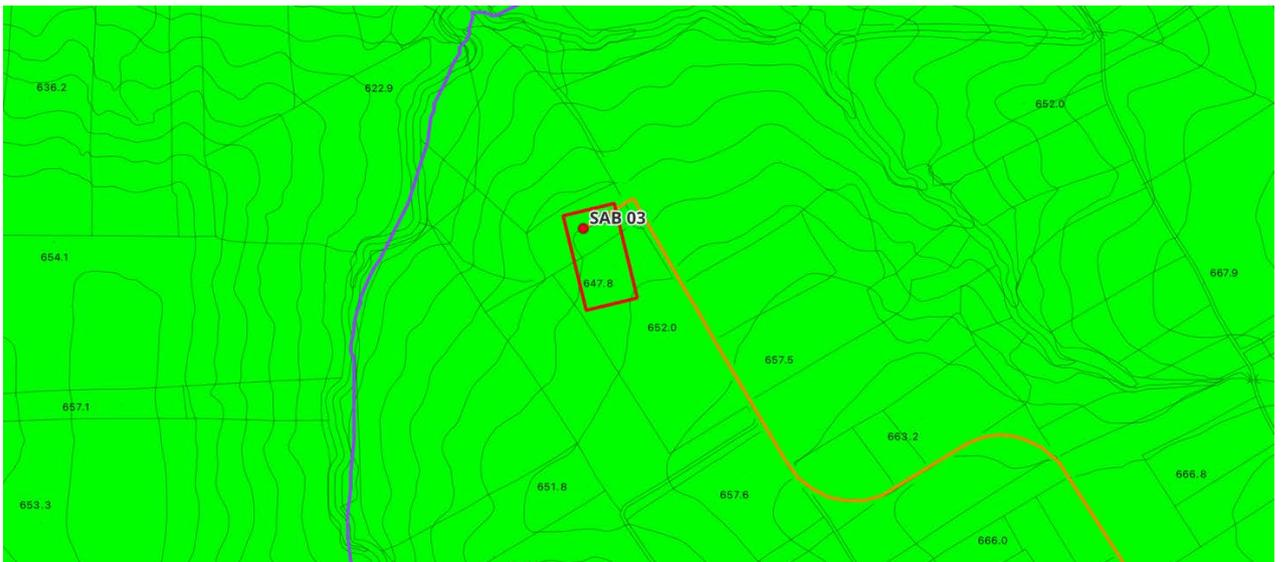
La zona di installazione dell'aerogeneratore SAB02 è cartografata dall'AdB Puglia a pericolosità geomorfologica elevata PG2: il sopralluogo puntuale eseguito in situ mostra un versante planare con pendenza inferiore agli 8° che non mostra alcuna criticità geomorfologica. Va inoltre precisato che la struttura verrà messa in opera con fondazione profonda di plinto su pali profondi almeno 20m.
