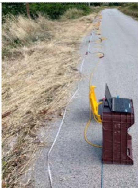
***Particolare dello stendimento sismico eseguito***
