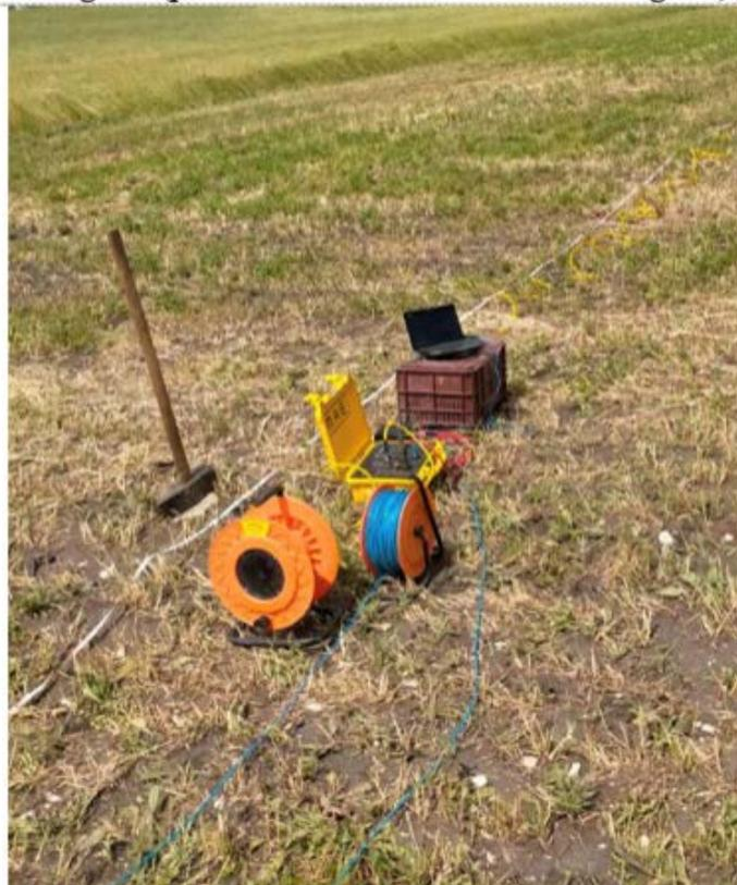
**Particolare dello stendimento sismico eseguito**
