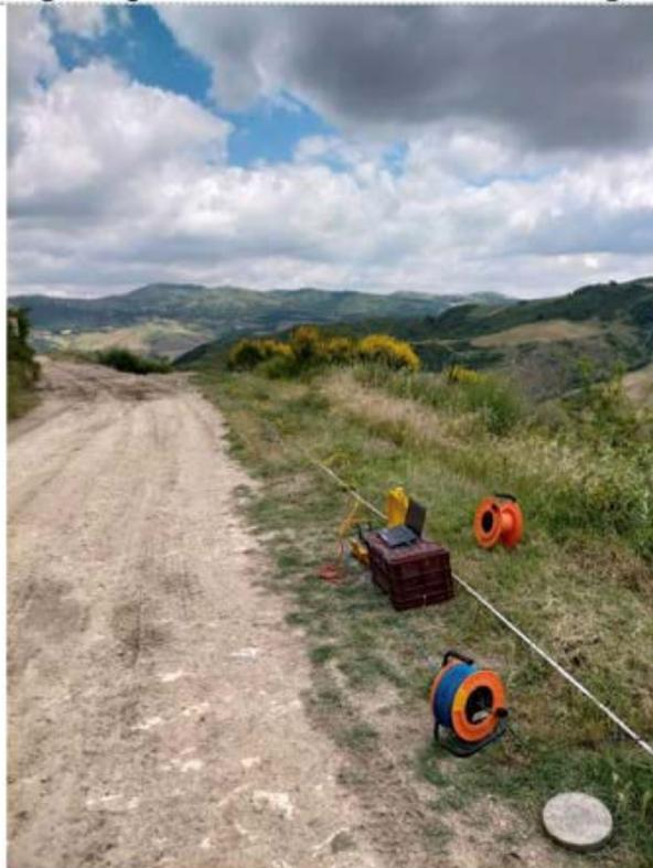
*Particolare dello stendimento sismico eseguito*
