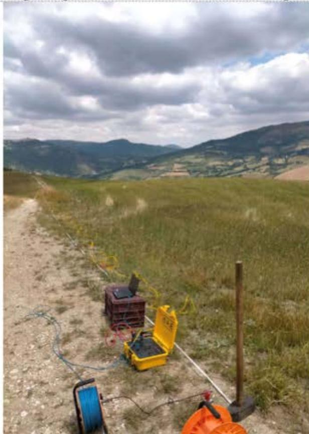
***Particolare dello stendimento sismico eseguito***
