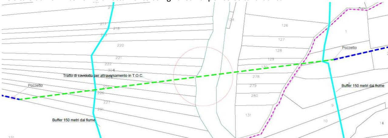
In particolare, in corrispondenza delle interferenze del cavidotto interrato con il reticolo idrografico, l'attraversamento della fascia di piena duecentennale, avverrà ad una profondità coerente con il calcolo del
