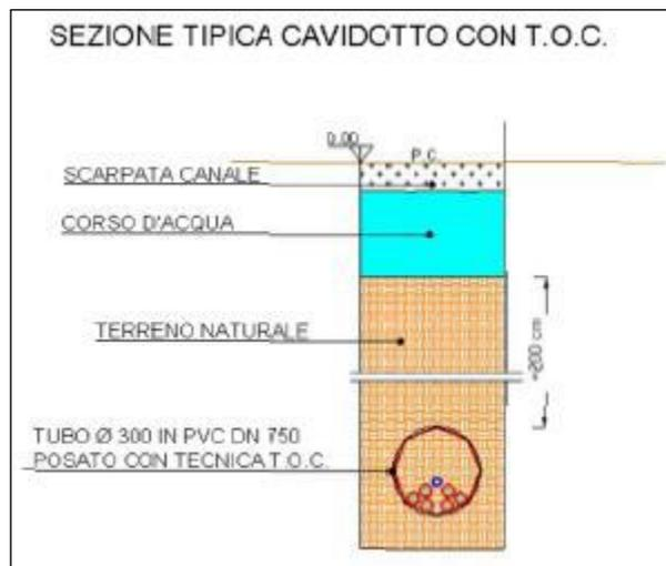
Figura 53 Schema tipo TOC
