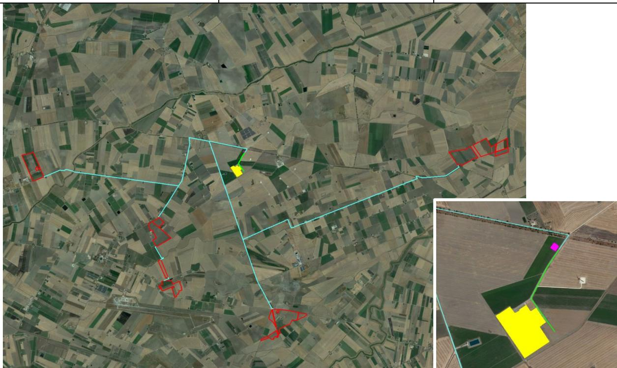
Figura 6: Inquadramento su Google Earth dell'area di impianto (in rosso), del tracciato del cavidotto di connessione MT (in ciano) e del tracciato del cavidotto AT (in verde); in magenta la Stazione Elettrica Utente (SEU); in giallo, la SE Terna.
