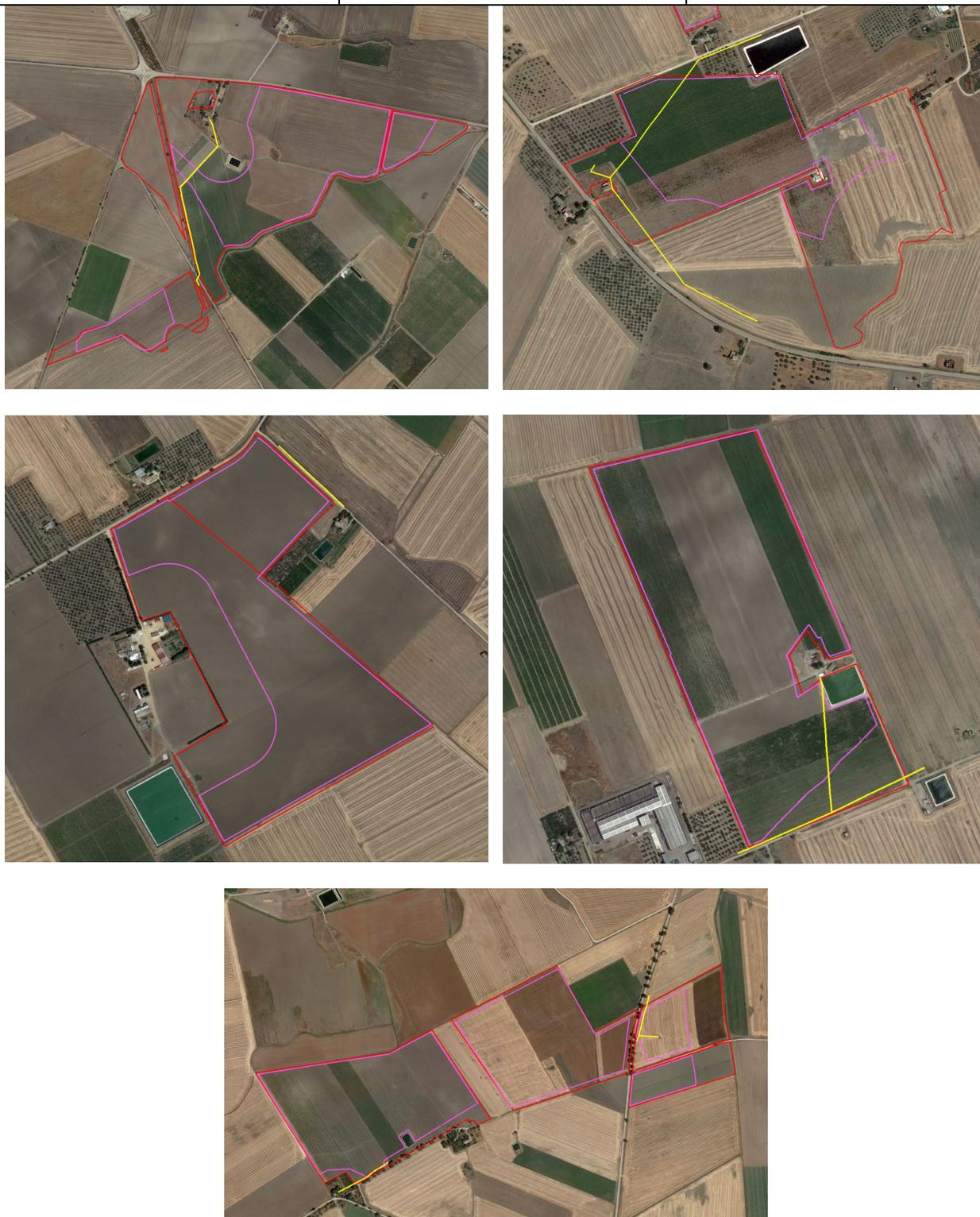
**Figura 29 – Linee elettriche BT nei pressi dell'area di impianto (in giallo). In rosso l'area di impianto; in magenta l'area utile che verrà occupata dal layout di impianto.**
