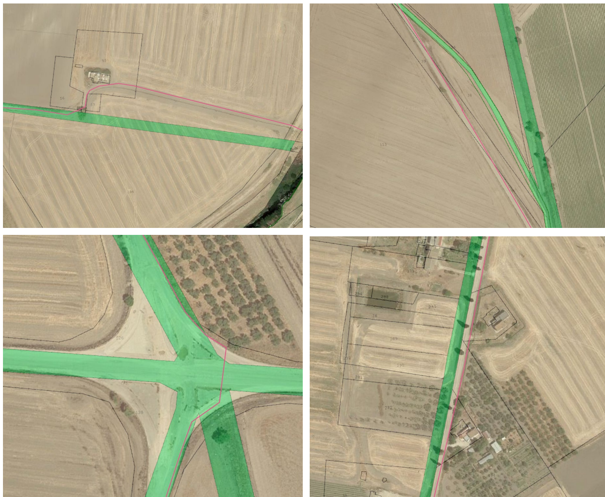
Figura 1: Esempi di incongruenza tra i corpi stradali presenti catastalmente e gli stessi presenti in sito. In verde le strade accatastate; in magenta il cavidotto MT.
